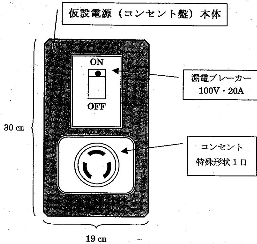
※上記のコンセント盤を電気メーターの近くに取り付けます。
